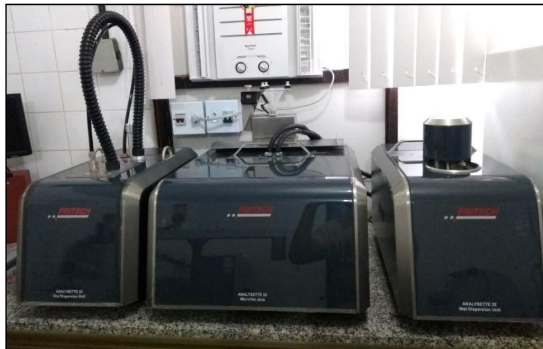
Figura 30. Analisador de partículas a laser; marca e modelo: FRITSCH/ ANALYSETTE 22; projeto: PRONEX e PRONEX-II; análise: determinação da distribuição granulométrica de partículas.
