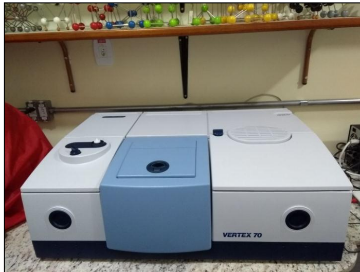
Figura 36. FTIR; marca e modelo: BRUKER / VERTEX 70; projeto: PRONEX; análise: identificação de grupos funcionais presentes na estrutura de substâncias.
