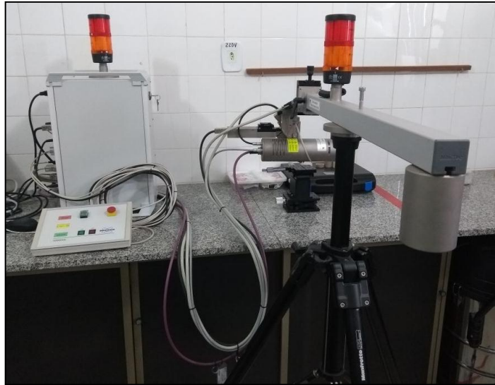
Figura 35. Espectrômetro \mu -FRX artaxportátil; marca e modelo: BRUKER / ARTAX; análise: determinação multielementar semiquantitativa.
