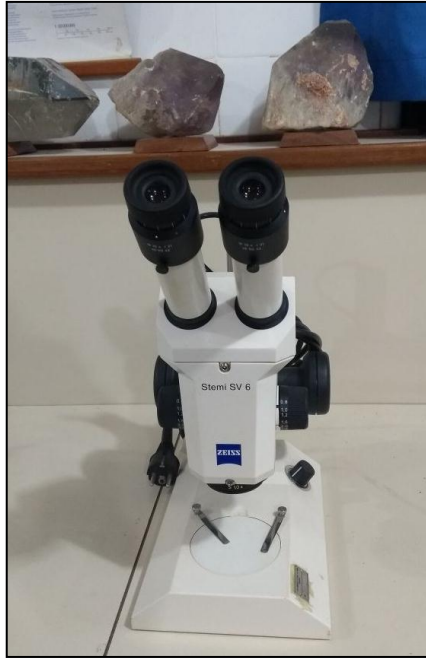
Figura 44. Estereomicroscópio; marca / modelo: Zeiss / Stemi V6 (cinco unidades); análise: imageamento com aumento de até 20x.
