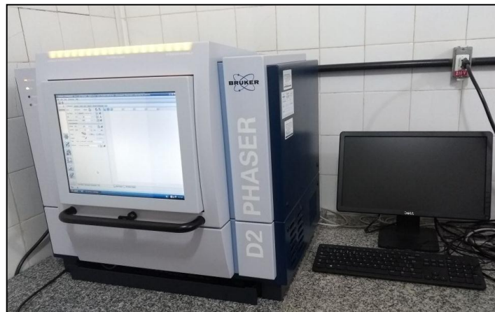
Figura 34. Difratorômetro de Raios-X; marca e modelo: BRUKER / D2 PHASER; financiador: 0110066400-0733/10 FINEP/FNDCT; identificação: 9004.2.1.271014; projeto FADESP: 2786; análise: identificação e caracterização de estruturas cristalinas.
