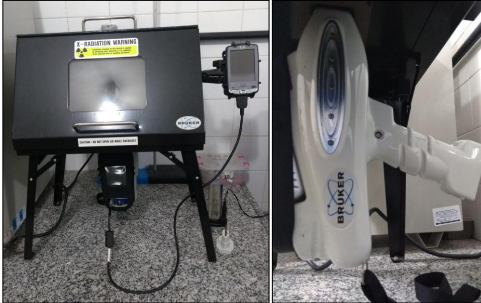
Figura 31. Espectrômetro por fluorescência de Raios-X portátil; marca e modelo: BRUKER/S1 TURBO SD ; financiador: 01.13.0144.00 277 FINEP/FNDCT; identificação FADESP: 9004.1.1.061014; projeto FADESP: 3369; análise: determinação multielementar semiquantitativa no intervalo de número atômico 11 a 92 (Na a U).
