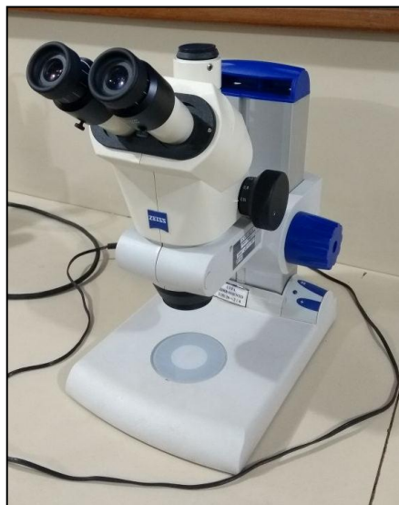
Figura 45. Estereomicroscópio; marca / modelo: Zeiss / AxioLab; análise: imageamento com aumento de até 20x.
