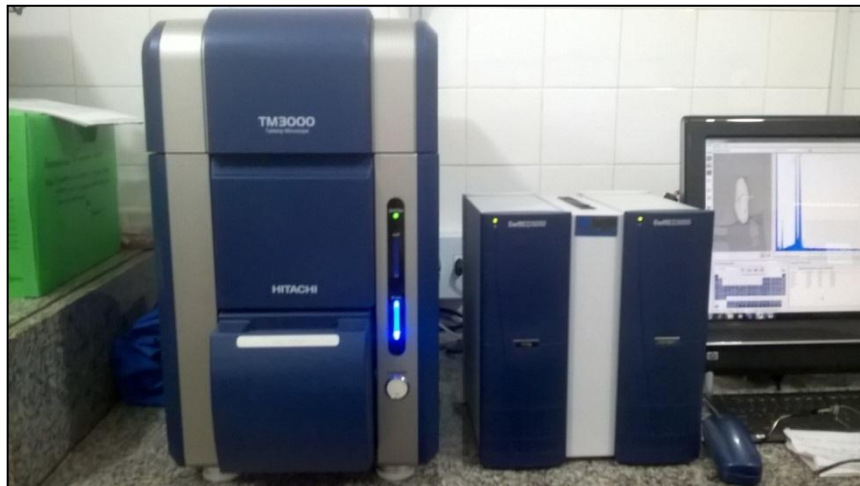
Figura 32. MEV de bancada com SED; marca e modelo: HITACHI/TM 3000; projeto: Pró Equipamentos; tombamento Universidade Federal do Pará: 249.777; análise: imageamento e determinação multielementar semiquantitativa.
