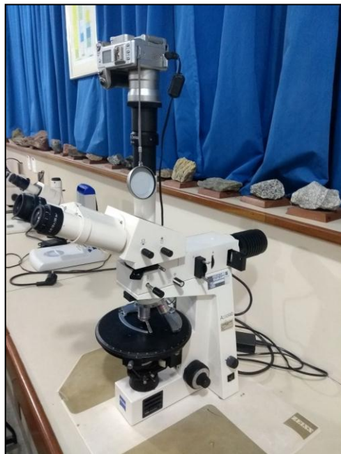
Figura 43. Microscópio petrográfico; marca / modelo: Zeiss / Axiolab; análise: imageamento com aumento de até 50x.
