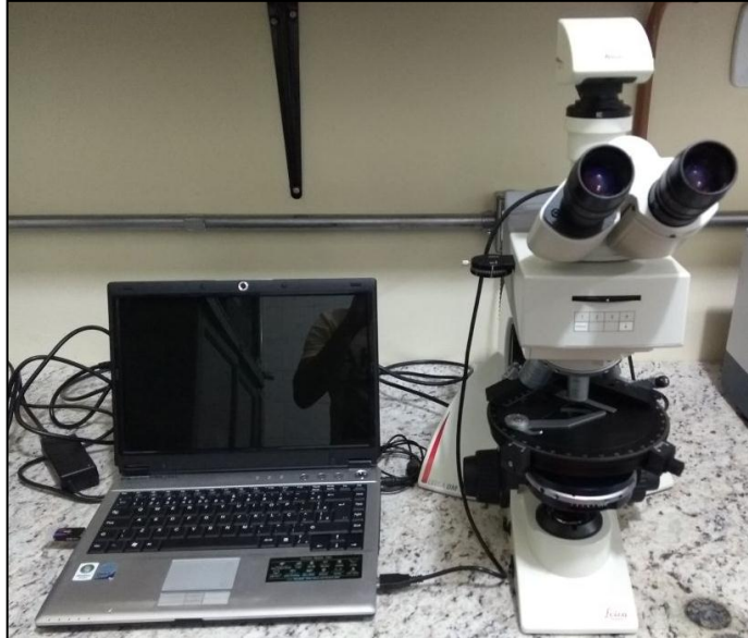
Figura 40. Microscópio petrográfico; marca / modelo: Leica / DM 2700 P; análise: imageamento com aumento de até 50x.
