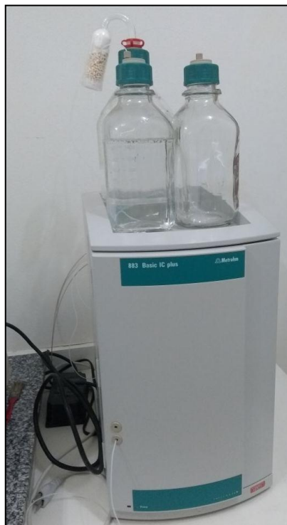
Figura 28. Cromatógrafo de íons; marca e modelo: Metrohm / 883 Basic IC Plus; tombamento Universidade Federal do Pará: 218.008; análise: determinação de ânions ou substâncias polares com ou sem supressão química, além de cátions.
